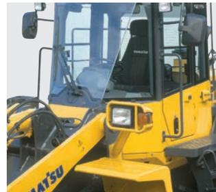
El área de la cabina es la mayor en su clase proporcionado al operador el máximo de espacio. Al montar la unidad acondicionadora de aire en el frente se aumentó la reclinación del espaldar del asiento y el ajuste de deslizamiento hacia atrás.
