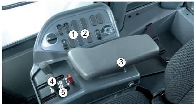
1. Interruptor de activación de corte (ON/OFF)
