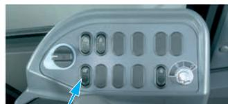
Interruptor selector dual de modo de potencia de motor
